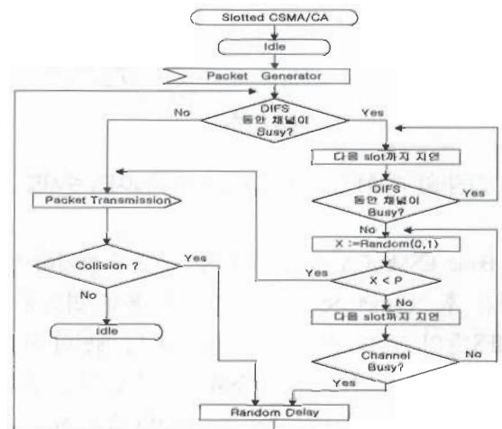
[그림 4] Basic CSMA/CA 방식의 패킷 처리 순서도
