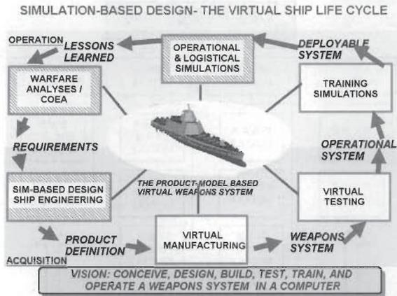
[그림 1] 미 해군의 시뮬레이션 기반 설계 시스템 개념도
