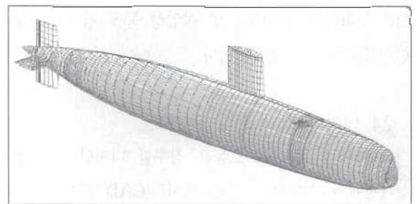
[그림 14] 선형설계 S/W를 이용한 선형생성 화면
