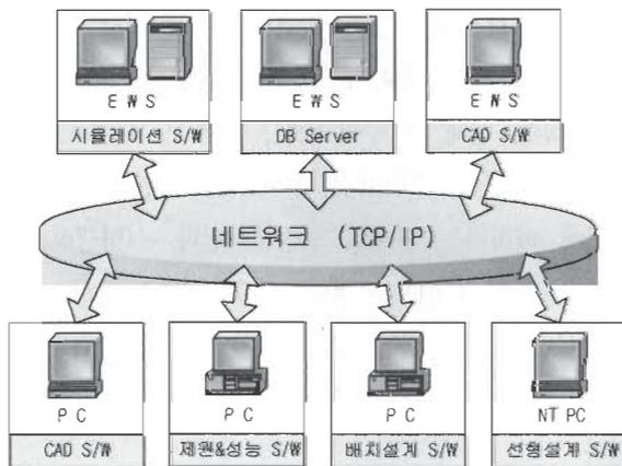
[그림 13] 형상화 시스템 H/W 구성도
