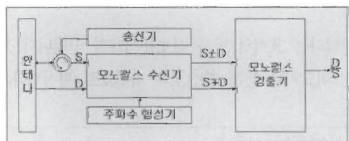
[그림 1] 모노펄스 시스템의 구조
