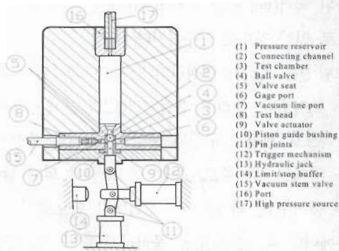
[그림 8] 측정어댑터(measuring head)의 구조
