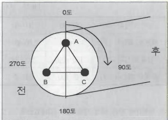
[그림 3] 센서 뒤틀림이 없을 때의 센서 기준배치
