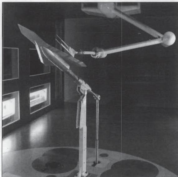
[그림 2] 풍동 측정부에 설치된 실험모델
