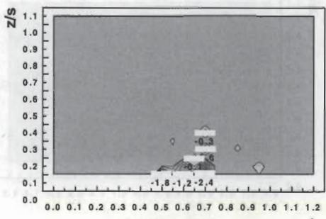
(d)  $x/c = 0.80$ [그림 5] LEX-ON 모델의 전압분포( $\alpha=16^\circ$ )
