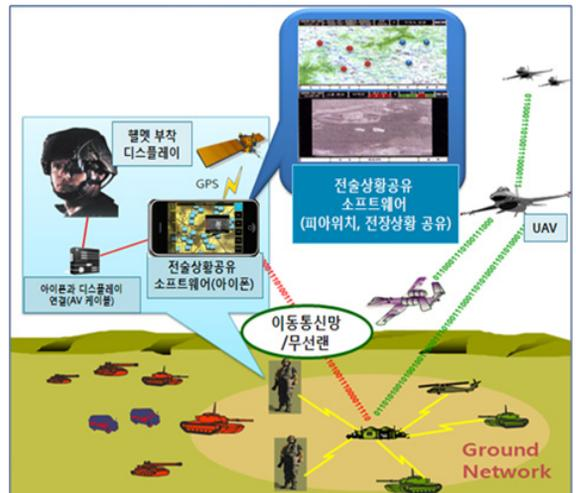
Fig. 5. 스마트폰을 이용한 병사용 지휘통제 시스템 구성도
