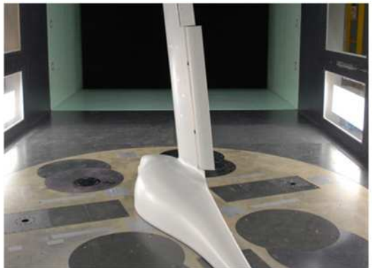
조종면 힌지모멘트 측정실험 (Control Surface Hinge Moment Measurement)
